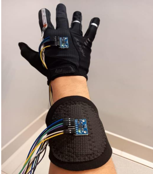
Figura 2: Disposição dos sensores da aparelhagem de controle na luva e no antebraço.
